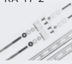
FKA 17-2 | Elemento de refuerzo para el bastidor soporte básico horizontal sobre tejado inclinado para captadores verticales. • Indicado para situaciones con sobrecarga de nieve entre 2 kN/m <sup>2</sup> y 3,1 kN/m <sup>2</sup> en tejado ondulado. • Sólo es aplicable a captadores verticales.<br><b>Necesario uno por cada captador.</b>                                                                 | 8 718 531 030 | <b>114</b> |
